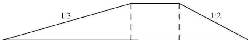
Рис. 15. Поперечный профиль плотины (масштаб 1:200)
