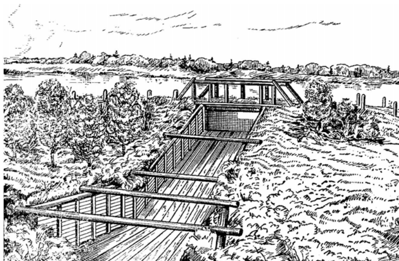
Рис. 35. Открытый деревянный водосброс
